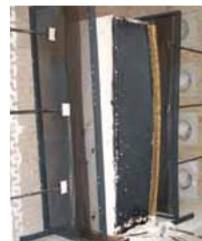
Armoire EXACTA série EFO après le test de résistance au feu.
